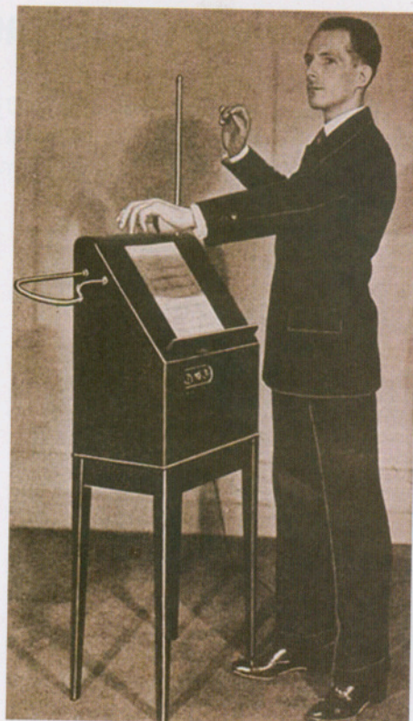
Das Bild zeigt Leon Theremin wie er sein Instrument spielt. Über die linke senkrechte Antenne im Bild ist die Tonhöhe steuerbar, die rechte liegende Antenne die Lautstärke. Das Theremin ist noch heute gebräuchlich und fand auch seinen Einsatz im Film (z. B. bei Star Trek).
